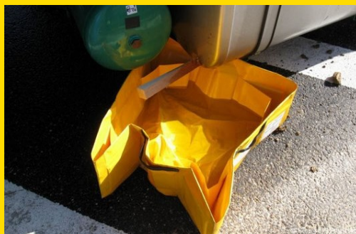
Réservoir de camion endommagé
