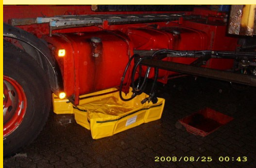
Fuite de diesel du réservoir du camion
