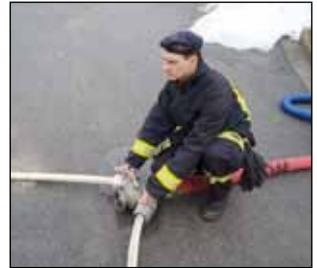
Je nach vorhandenem Druck dauert der Füllvorgang unterschiedlich lange. Der Füllvorgang muss dauernd überwacht werden.
