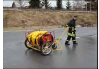
Hochwasserschutz-Schläuche bis zu 150 kg können von einer Person aufgeladen, transportiert und ausgerollt werden. Ohne den
