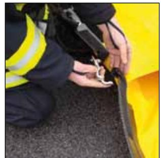
Die Verbindungen lassen sich auch unter Zug öffnen. Das ist bei Karabinerhaken nicht möglich.
